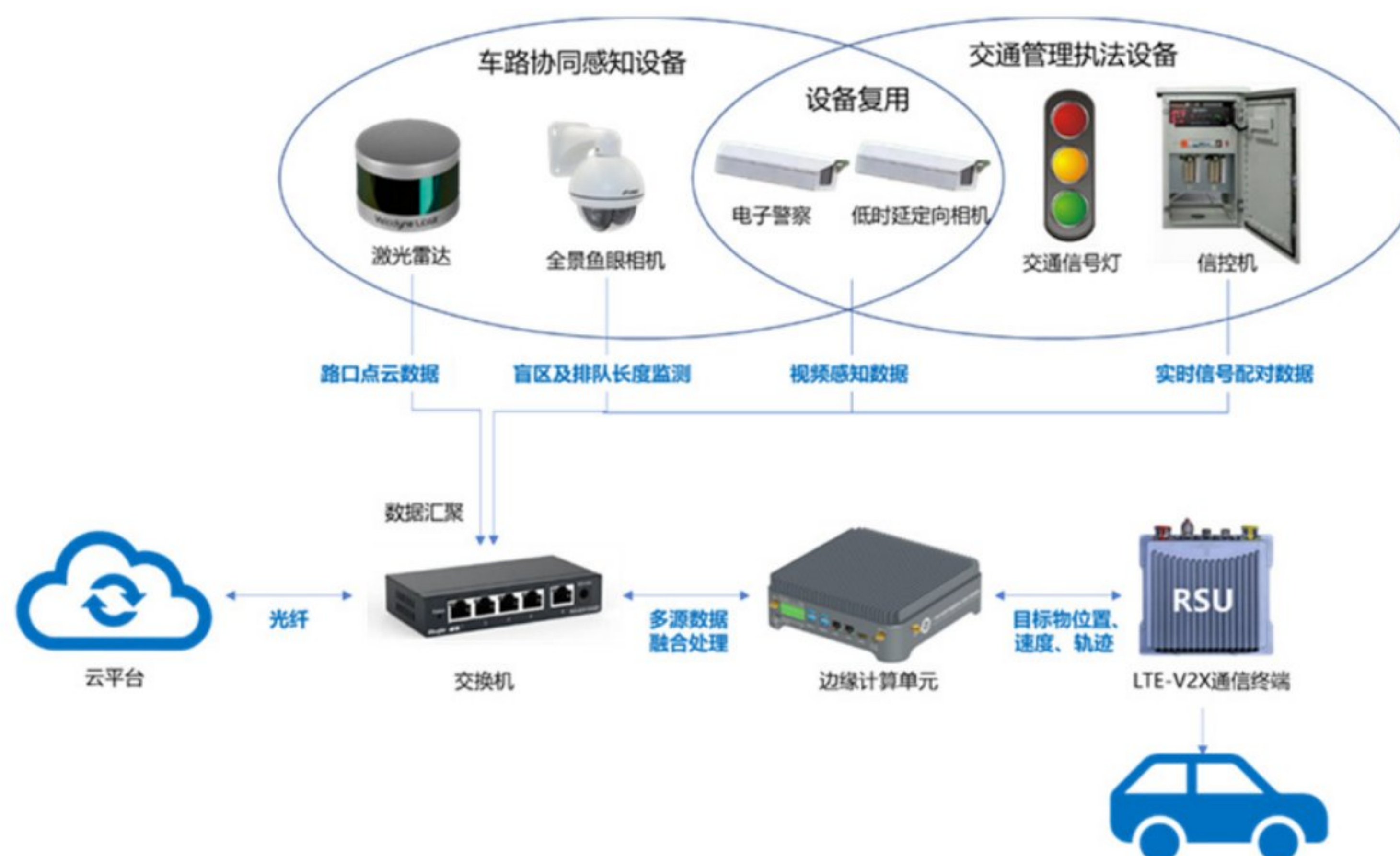
图3-10 北京试点路口设备复用方案
